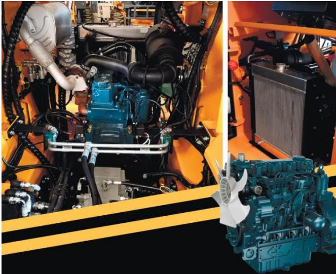
Применение в конструкции мини-погрузчика мощных гидравлических моторов Poiclein обусловлено достижением эффекта пониженного нагревания гидравлического масла, что значительно расширяет предельное время непрерывной работы в режиме максимальной нагрузки.
